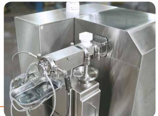
Den NANO 16 gibt es auch als Variante mit 12D Verfahrenslänge und einer nochmals kleineren Mikro-Kolbenbeschickung. Dadurch können Kleinstmengen von bis zu 10 cm<sup>3</sup> gefahren werden.
