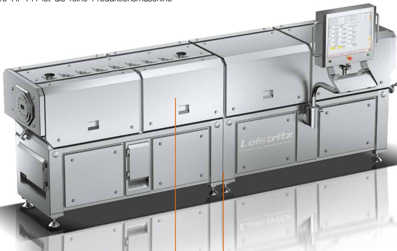
Das Verfahrensteil und der Antrieb sind von einer Haube aus Edelstahl umgeben. Die Oberflächen sind glatt, um leichte Reinigung zu gewährleisten. Die Haube kann durch einfache Handgriffe jederzeit entfernt werden, um notwendige Rüstarbeiten an den Zylinderelementen durchführen zu können.
